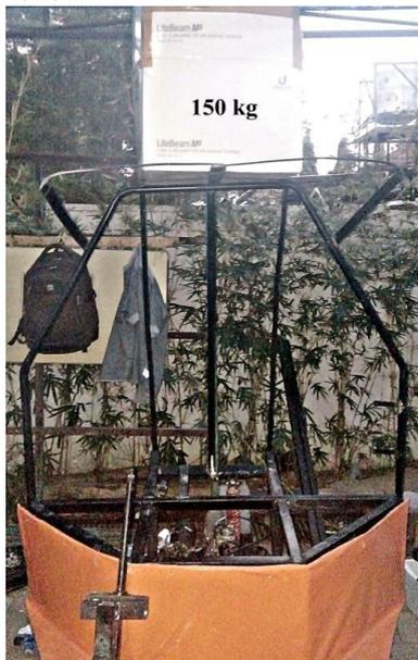
Gambar 6. Pengujian Rollbar
